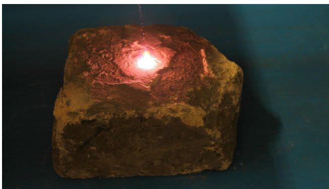
Bild 3: Gebrauchte Feuerfestmaterialien werden mit Laser-Messungen erkannt und CO 2 -sparend wiederverwendet. © Fraunhofer ILT, Aachen.
