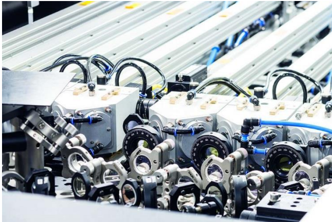
Bild 1: Die Skalierung der Multi-kW-UKP-Faserlaser beruht auf der kohärenten Kombination mehrerer Einzelstrahlen. © Fraunhofer IOF, Jena / Walter Oppel.
