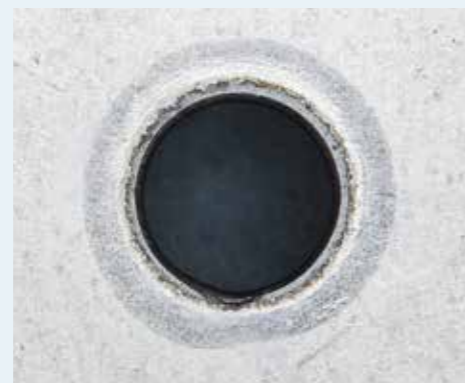
1 Prozess der Laserkantenveredelung. 2 Laserkantenveredelte Probe für Lochaufweitungsversuch.
