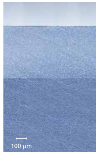
1 Oben: Lasergeschweißter PA6.6-GF20-Probekörper. Unten: Bruchbild nach Zug-scherbelastung mit Versagen des Grundmaterials außerhalb des Schweißnahtbereichs. 2 Mikroskopische Analyse der Fügeebene ohne erkennbare Beschädigungen oder Wärmeeinflusszone.
