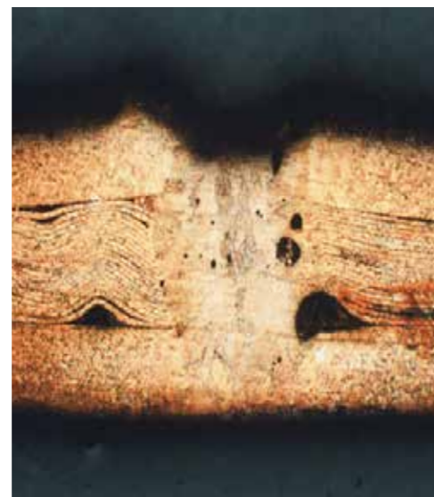
1 Laserstrahl-Mikroschweißen von Elektrodenstapeln mit einer Wellenlänge von 1070 nm. 2 Querschliff der Kontaktierung der Kupferfolien an den Ableitertab.
