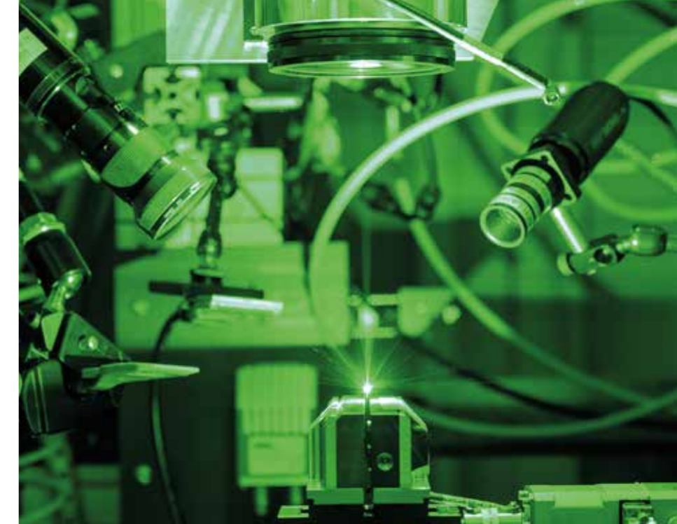
1 Analyse von Dampfkapillaren aus Synchrotrondaten, © TRUMPF. 2 Laserstrahlschweißungen mit grünem Laser, © TRUMPF.
