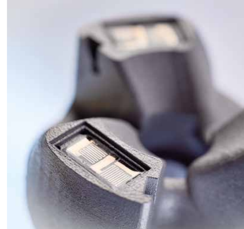
1 Durch LPBF-Prozess fertiggestelltes Bauteil mit integrierter Sensorik. 2 Gedruckte Dehnungsmessstreifen in unvollständigem AM-Bauteil.
