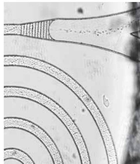
1 Quarzglas-Chip mit zwei Dean-Flow Sortierstrukturen. 2 Separierter Blutzellstrom an einer Verzweigung im Sortier-Chip.
