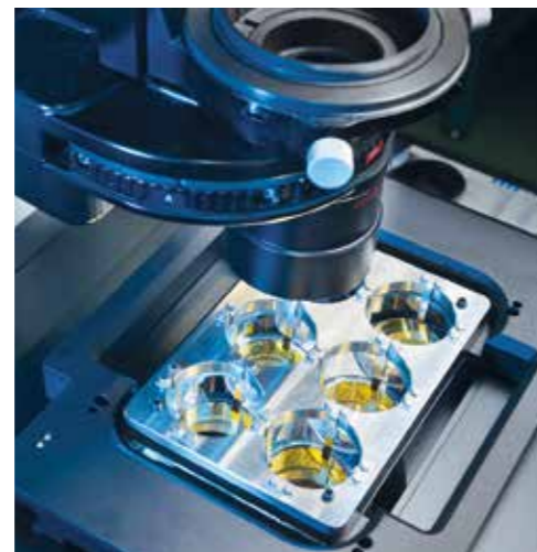
1 Mikroskop mit integrierter Highspeed-Bildererkennung und lasergestützter Zellseparation. 2 Substrathalter zum Auffangen und Kultivieren transferierter Zellen im Multiwell-Zellkulturgefäß.
