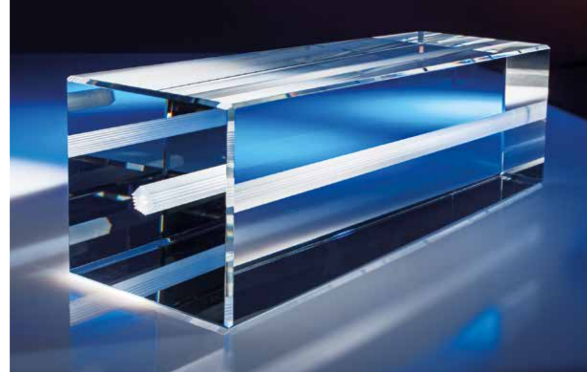
200 mm lange, lasergebohrte PCF-Geometrie in BK7.
