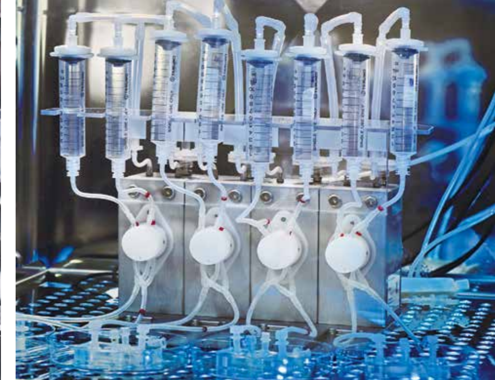
1 OoC aus PDMS mit sich kreuzenden Kanälen, die durch eine Membran getrennt sind. 2 Zellkultivierung in vier OoCs mit automatisierter Perfusion.
