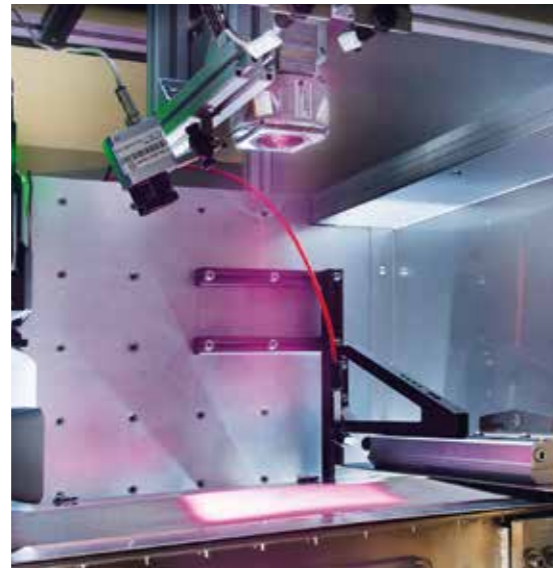
1 Rolle-zu-Rolle-Anlage für die Herstellung von Batterieelektroden im Battery Lab des Fraunhofer ILT. 2 Lasertrocknungsmodul mit angepasster Bearbeitungsoptik.
