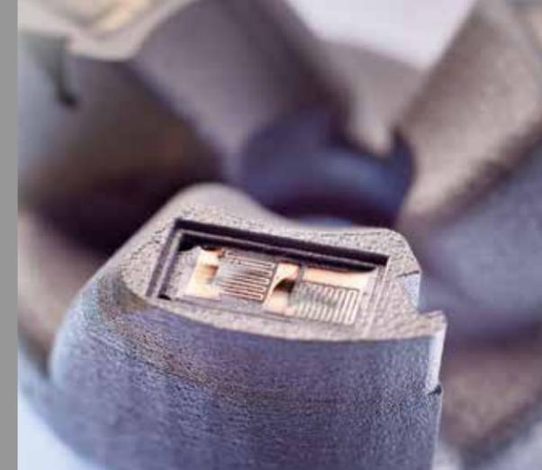
*Fühlendes Werkzeug der Zukunft: Fräskopf mit integrierter Sensorik zur Temperatur- und Druckmessung.*
