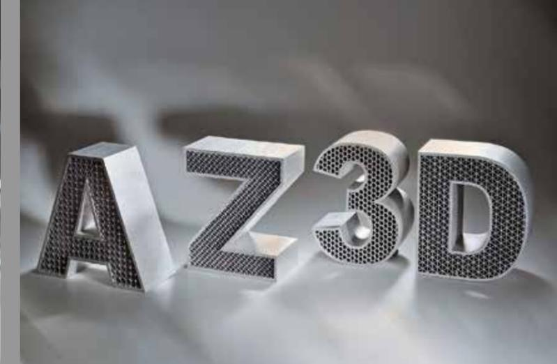
Additiv gefertigte Buchstaben mit integrierten Leichtbaustrukturen.
